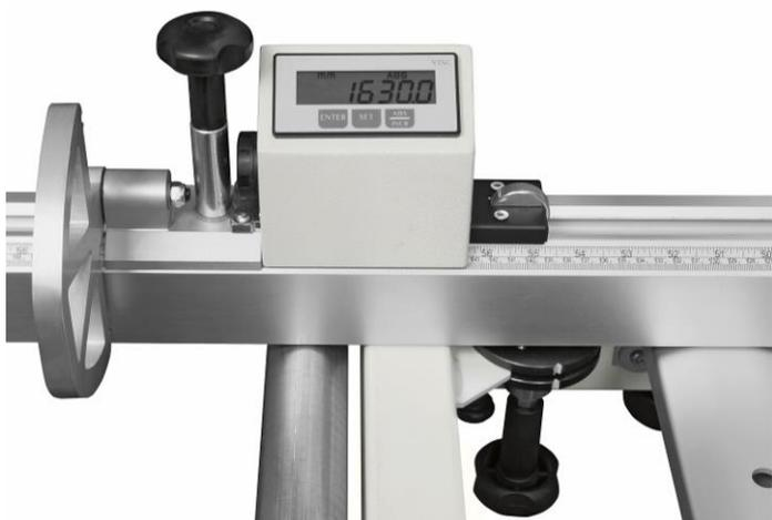
Рамный стол для форматной обрезки, для быстрого позиционирования угловых резов
